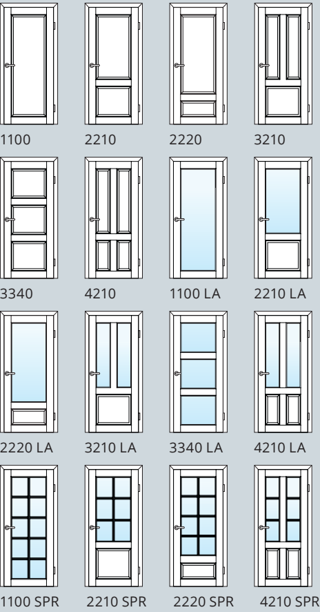
Profiltür, Weißlack, Türblatt mit Lichtausschnitt und Sprossen, Zarge mit 2 Rillen
