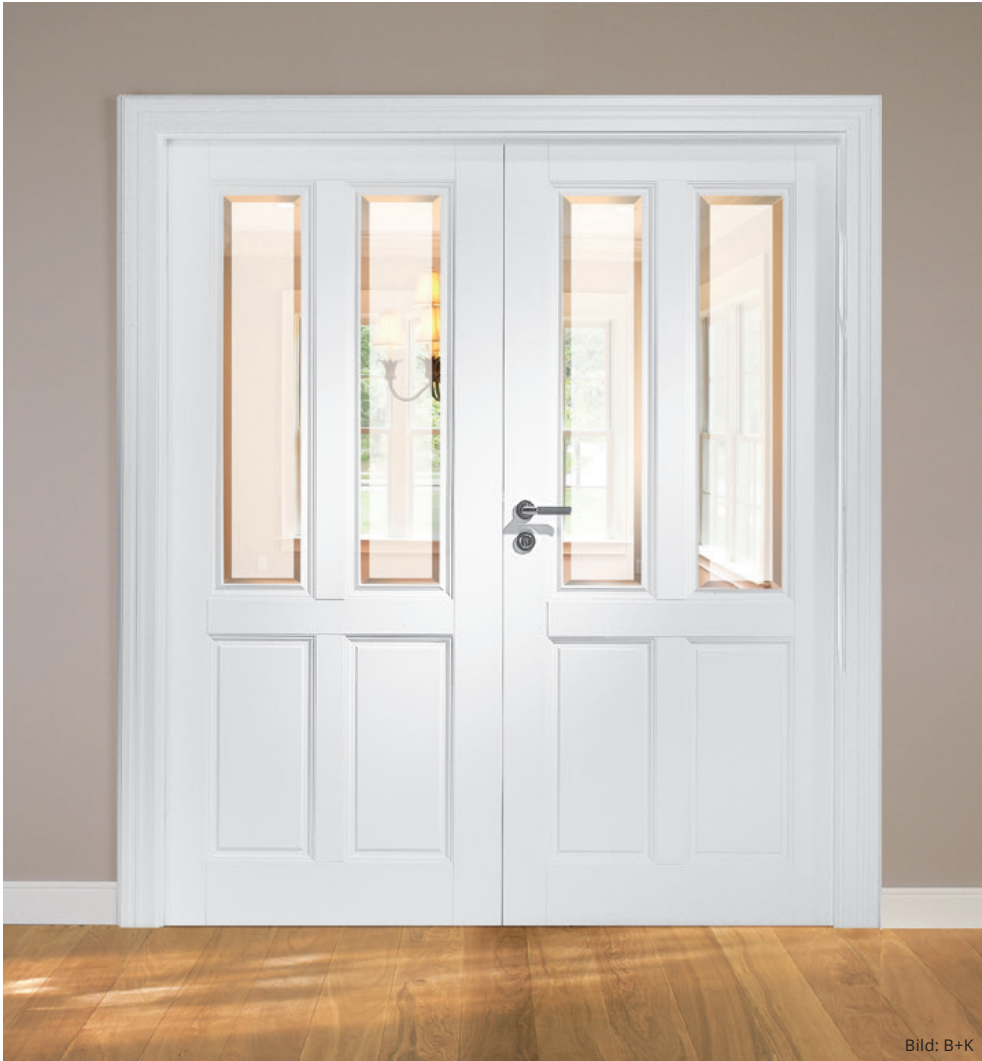
Profiltür, zweiflg., Weißlack, mit Lichtausschnitt, Glas Satinato mit Facettenschliff, Zarge LD
