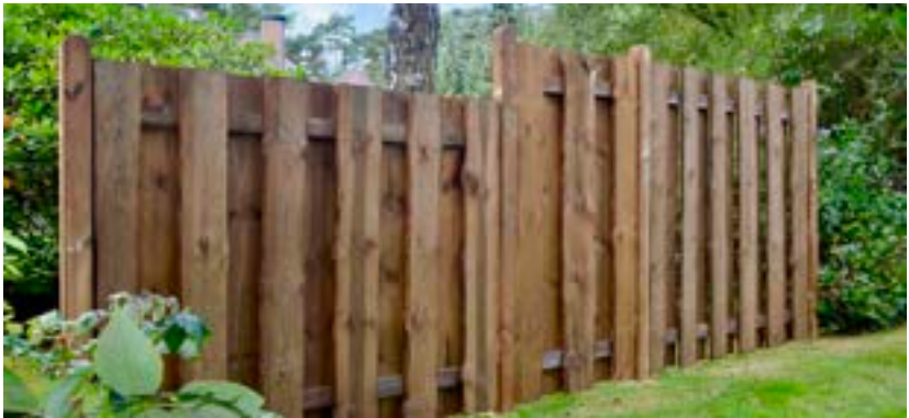
Bohlenzaun Seeland aus sägerauhen Bonanzabrettern ca. 16 mm, Breite ca. 11-16 cm, mit Bast und Rindenresten, genagelt, Riegel ca. 30 x 60 mm, druckimprägniert braun 180 x 180 cm
