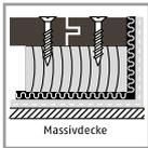
3. Beim Verschrauben ist darauf zu achten, dass die Schrauben nicht bis in die Massivdecke reichen. Alle Isolierungen an der Wand sollten bis zur Belagsoberkante hochgezogen werden (ca. 10 cm), und die Folie sollte – auch bei nachfolgenden Arbeiten – unbeschädigt bleiben. Die Folienüberlappung sollte idealerweise unter den Lagerhölzern angeordnet werden.
