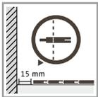
1. Zur Vermeidung von Knarrgeräuschen sollte ein Platz für eine Dehnfuge von 15 mm zwischen Wand und Verlegeplatte berücksichtigt werden. Für die erste Reihe sollten die Federn abgenommen werden. Bei größeren Flächen (mehr als 10 m Länge) werden dazwischenliegende Dehnfugen erforderlich.
