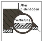
3. Vertiefungen in der vorhandenen Decke sollten durch lose, fäulnisbeständige Schüttgüter (wie z. B. natürlichen Blähschiefer) aufgefüllt werden. Bitte keinesfalls Sand verwenden!
