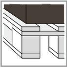
Vor der Verarbeitung muss die Verlegeplatte über mehrere Tage zur Anpassung an das Raumklima nässegeschützt an ihrem Einbauort gelagert werden. Die Raumtemperatur sollte über 10 °C liegen.
